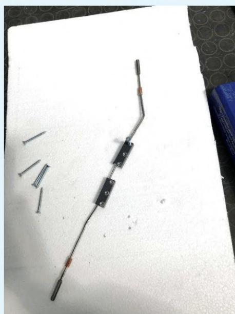
Zdjęcia systemu bezpieczeństwa po teście z klapą/klapą (waga 174 kg).
