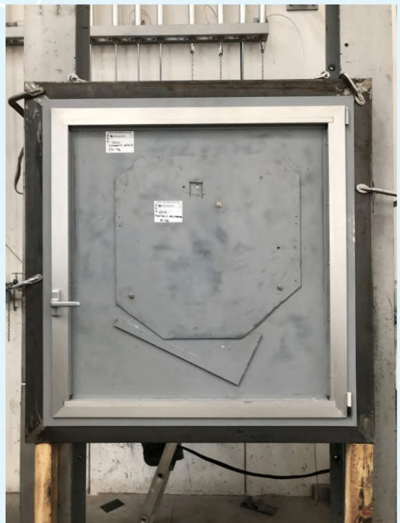
Fotografie próbki z drzwiami uchylnymi / klapowymi (ważone do 174 kg po prawej stronie).
