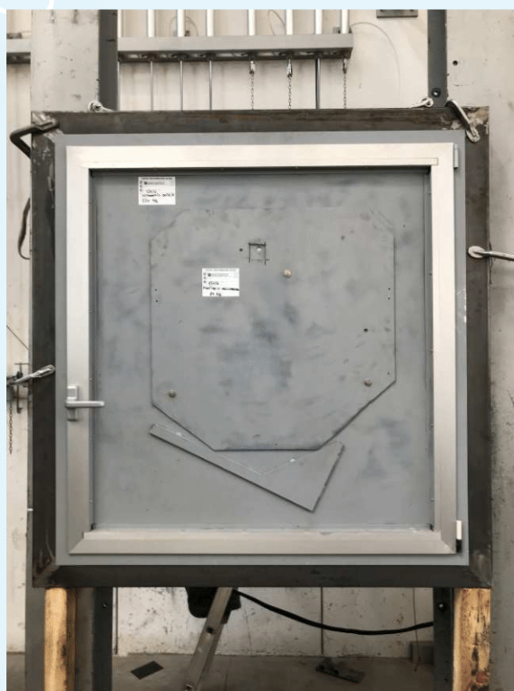
Fotografie próbki z drzwiami uchylnymi / klapowymi (ważone do 174 kg po prawej stronie).
